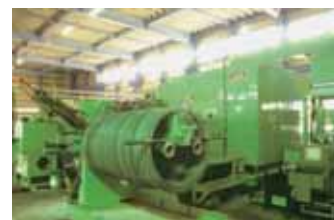
■冷間鍛造設備「6段式パーツフォーマー」
