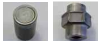
■左：コイル状素材を切断したところ ■右：冷間鍛造加工された鍛造素材
